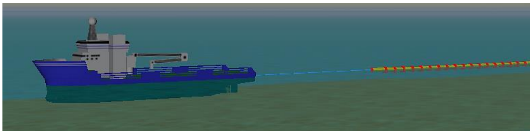
Figura 7.12 - Rebocador e conduta submarina com os blocos de lastro, PM4655
