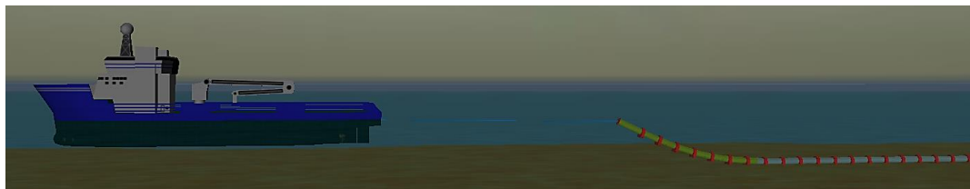
Figura 7.16 - Término do afundamento (Imersão da extremidade terra), PM4655
